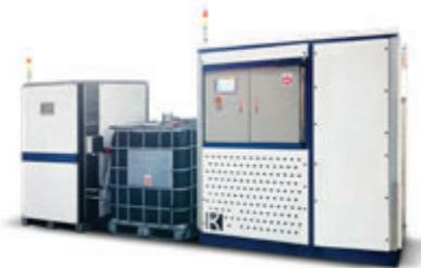
產氫機是使用甲醇水，經由重組及變壓吸附 (Pressure Swing Absorption, PSA) 純化，產生高純度氫氣 (99.999%)。工業廣泛應用於製程氣體，如氫氣還原爐、熱處理爐及半導體、光電製程等。
